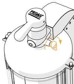
Наполните бутылку чуть ниже желаемого уровня и перекройте дренажный канал, повернув винт дросселя по часовой стрелке до упора.
