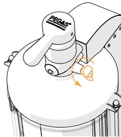
Приоткройте дренажный канал, повернув винт дросселя против часовой стрелки. Для выравнивания давления в таре с атмосферным требуется примерно 10 с.
