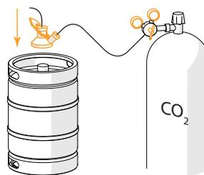
Для поддержания чистоты до следующего использования устройства не сливайте из линии подвода напитка воду, использованную для промывки на последнем этапе обработки. Подключите к кегу с напитком снятую с промывочного кега заборную головку.
