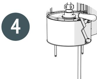
Установите устройство на столешницу в предварительно просверленные отверстия.
