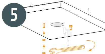
Наденьте шайбы, накрутите гайки на шпильки и закрепите устройство на столешнице, затянув гайки ключом.
