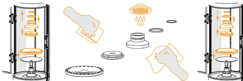
Снимите подложку с подставки для бутылки. Выкрутите втулку наливной головки, отсоедините прокладку, извлеките из канавки уплотнитель, из отверстия – прокладку. Протрите демонтированные детали губкой, смоченной в теплой воде с добавлением нейтрального моющего средства.
