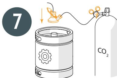
Убедитесь, что редуктор газового баллона настроен на давление 1 бар (15 psi). Подключите заборную головку к промывочному кегу.
