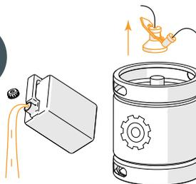
Отсоедините заборную головку от промывочного кега, не демонтируя шланги линий подвода газа и напитка. Опорожните дренажную емкость.
