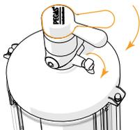
По истечении времени выполняемого этапа обработки закройте канал подвода напитка, затем закройте дренажный канал.
