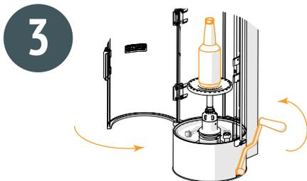
Осуществите поджим горловины к наливной головке и закройте защитную дверцу.
