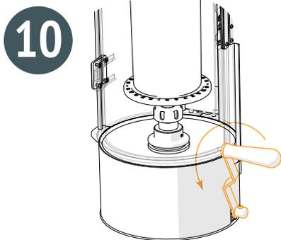
Опустите наполненную тару, повернув ручку управления узлом поджима против часовой стрелки до упора, а затем откройте защитную дверцу устройства.
