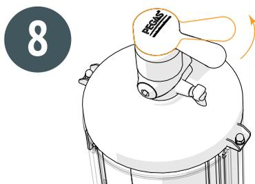
Откройте дренажный канал, а затем канал подвода напитка. Жидкость через открытый дренажный канал будет постепенно наполнять дренажную емкость.
