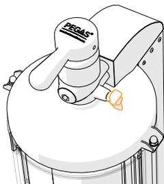
Вращая винт дросселя в пределах 1 оборота, подберите скорость наполнения в зависимости от интенсивности пенообразования.
