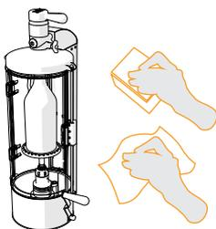
Протрите внутреннюю поверхность колбы губкой, смоченной в теплой воде с добавлением нейтрального моющего средства. Затем внутреннюю и наружную поверхность колбы протрите чистой влажной тканью. Вытрите колбу насухо изнутри и снаружи чистой безворсовой салфеткой.
