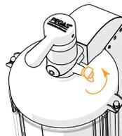
Приоткройте дренажный канал, медленно повернув винт дросселя против часовой стрелки – тара начнет наполняться напитком.
