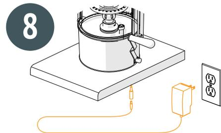
Соедините блок питания с соответствующим разъемом устройства под столешницей. Подключите устройство к электросети.
