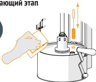
Прочистите канал дренажа колбы мини-ершом, затем протрите сливное отверстие губкой, смоченной в теплой воде с добавлением нейтрального моющего средства.
