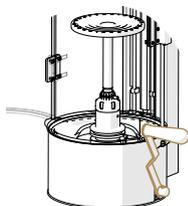
д. подожмите тару к наливной головке, повернув ручку узла поджима по часовой стрелке;
