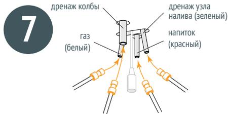
Соедините шланги подвода газа, напитка и дренажа (колбы и узла налива) с соответствующими трубками устройства с помощью JG-соединений.
