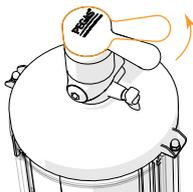
Включите подачу углекислого газа, повернув ручку управления узлом налива от себя.
