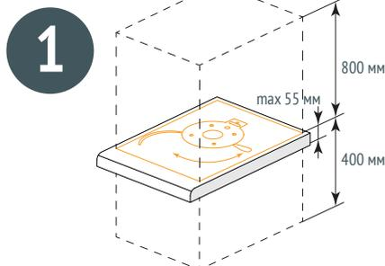
Убедитесь, что место установки соответствует габаритам, указанным на рисунке и нанесенным на трафарет. Закрепите трафарет и с его помощью нанесите разметку на столешницу.
