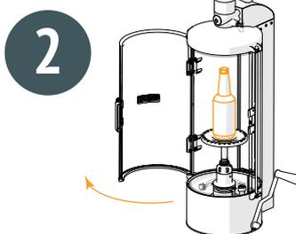
Откройте защитную дверцу, установите на подставку пустую промывочную тару небольшого объема, предварительно настроив узел поджима на ее высоту.
