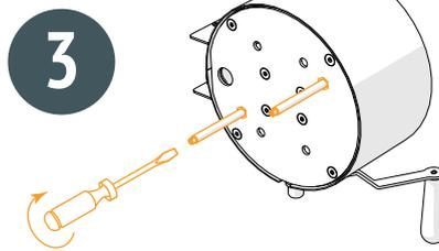
При помощи отвертки вкрутите шпильки в резьбовые отверстия на дне устройства.
