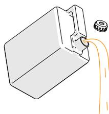
Следите за наполнением дренажной емкости, в которую будет стекать промывочная жидкость. Опорожните емкость при наполнении.
